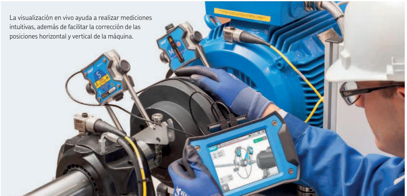
El avanzado sistema de alineación de ejes por láser con mejor capacidad de medición y creación de informes
