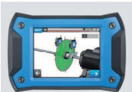
La medición libre permite comenzar a realizar mediciones de alineación en cualquier ángulo y finalizar con un barrido angular de solo 90°.
