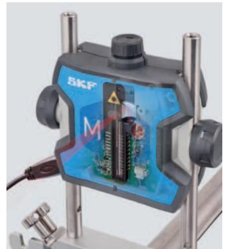
La visualización en vivo ayuda a realizar mediciones intuitivas, además de facilitar la corrección de las posiciones horizontal y vertical de la máquina.
