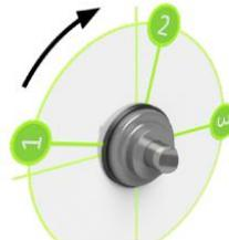
**Método Tripoint™** . En el método Tripoint, la condición de alineación se calcula tomando tres puntos mientras el eje gira al menos 60°. En este método, todos los puntos se toman manualmente.
